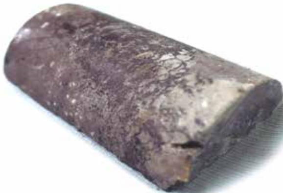
Silica Argl avanzada. Sondaje DHSF18- 218, Prof. 372.00 m. Brecha hidrotermal silícea mineralizada con relleno de covelita, calcosina, pirita, enargita y arcillas.
