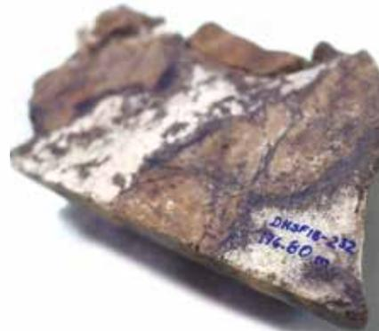
Mtx silicea con cemento de Cv - Cc, EN, py. Sondaje DHSF18- 232, Prof. 176.80 m. Brecha hidrotermal de matriz silícea cementada por covelita-calcosina, enargita, pirita y arcillas. Ley: Au: 0.80 ppm, Ag: 12 ppm, Cu: 8.94 %.
