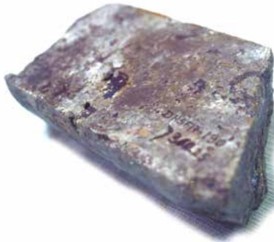
Silica masiva craquelada con relleno de Cc-CV. Sondaje DHSF17- 190, Prof. 360.25 m. Canal de sílica masiva craquelada con relleno - calcosina, covelita, pirita y débil contenido de enargita. Ley: Au: 0.11 ppm, Ag: 1.6 ppm, Cu: 0.70 %.
