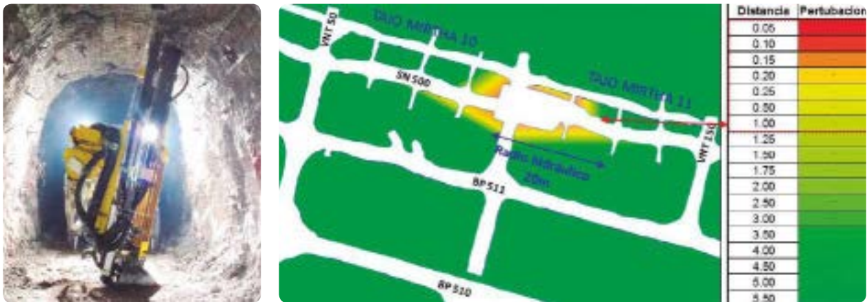
Figura1. Equipo de perforación Simba S7D Atlas Copco (izq.). Evaluación del daño al macizo rocoso Blastware (der.)
