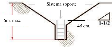
PORCION MAS BAJA VERTICALMENTE CON TALUD CON SOPORTE TIPO DE SUELO C
