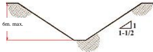
TALUD SIMPLE TIPO DE SUELO C
