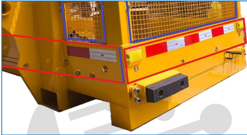
Fig.16: Modelo de cintas y tachas reflectivas
