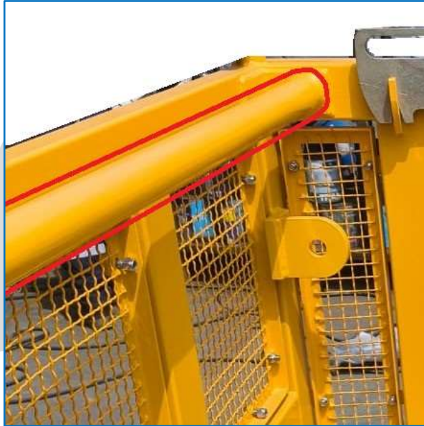
Fig.9: Baranda interna para evitar atrapamientos.
