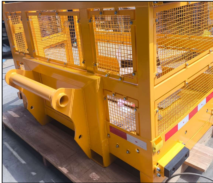
Fig.3: Imagen referencial de modelo de anclaje de canastilla.
