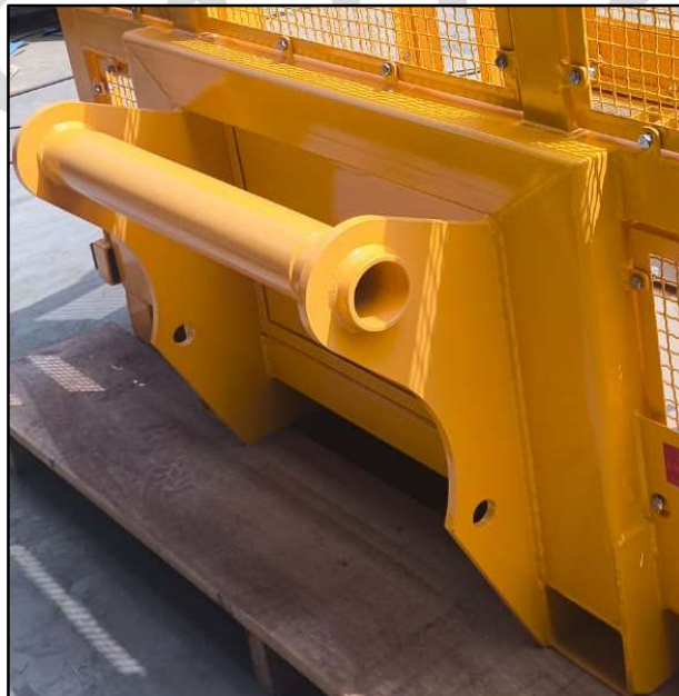
Fig.2: Imagen referencial de modelo de anclaje de canastilla. (Modelo de imagen de Manutou1030/33)
