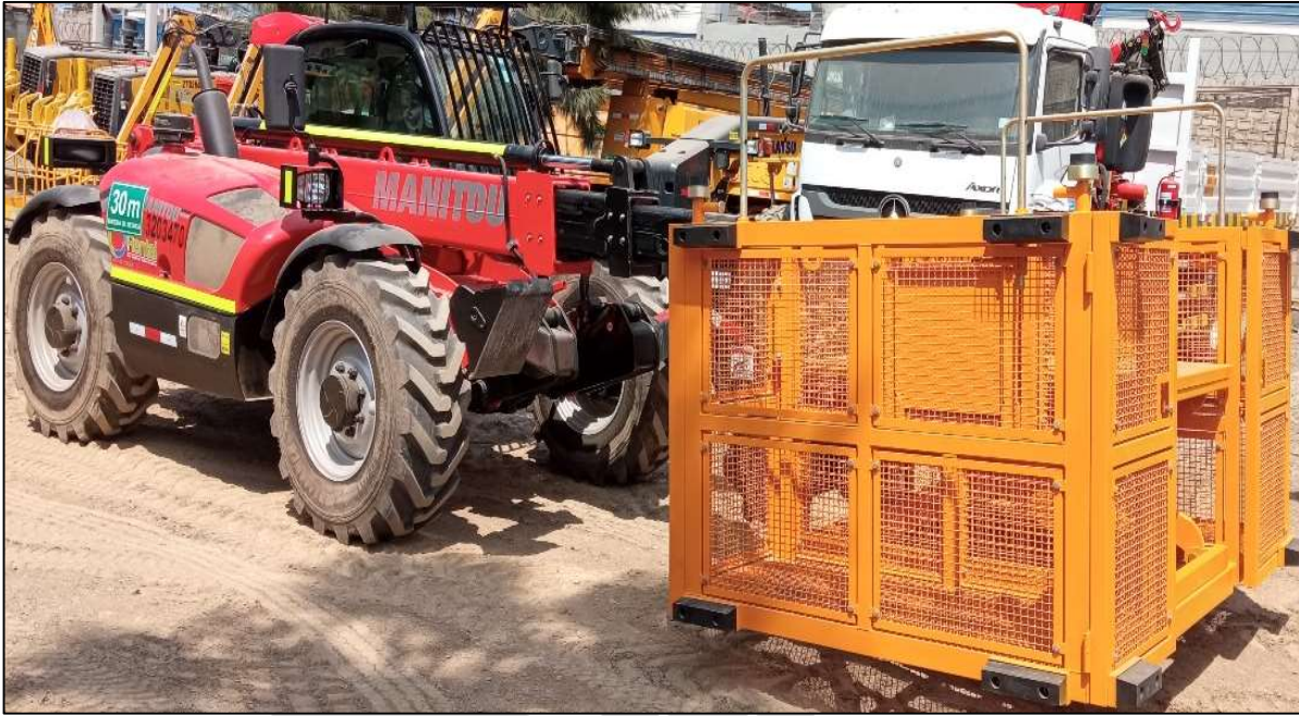
Fig.1: Modelo referencial de Canastilla usada en un equipo manipulador
