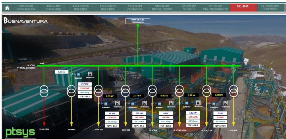
Imagen N°11: Monitoreo de Medidores de la Subestación
